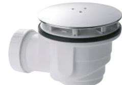
614 PILETTA DOCCIA CON PIASTRA CROMATA Ø 120 USCITA SCARICO Ø 50 MM PER PIATTO DOCCIA CON FORO Ø 90 MM WASTE FOR SHOWER TRAY, WITH CHROME PLATED COVER Ø 120, OUTLET PIPE 50 MM, FOR SHOWER TRAY WITH HOLE Ø 90 MM
